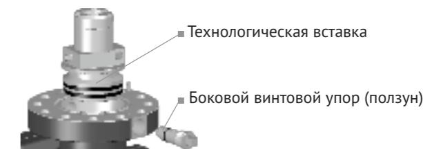
⚙️ Отверстия на нижнем фланце выполняются в виде эллипсов для возможности присоединения к различным типам арматуры устья.
