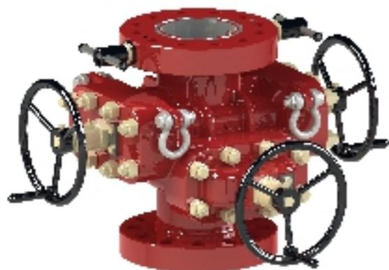
⚙️ Соединив плашечный превентор с глухой шиберной задвижкой и комплексом герметизирующих вставок, наша компания создала принципиально новую конструкцию превентора, благодаря которой впервые стало возможным проведение всех видов ремонта скважин без снятия превентора с устья, что значительно экономит затраты на ремонт!
